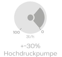
Bei Portalwaschanlagen und Waschstraßen erfolgt die Verwendung mittels Dosierpumpe. Wir empfehlen die Verwendung von Osmosewasser und eine Dosierung von rund 15 ml/min, wobei versucht werden sollte, den Prozentsatz der Pumpe bei 30 % aufrechtzuerhalten.
