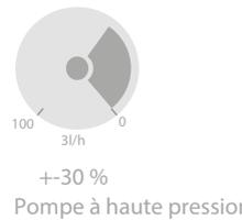
Dans les portiques et stations de lavage, le produit est appliqué à l'aide d'une pompe doseuse. Il est recommandé d'utiliser de l'eau osmosée en maintenant le dosage autour de 15 ml/min, en essayant de maintenir le pourcentage de la pompe autour de 30 %.
