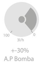
Em máquinas e túneis de lavagem o produto aplica-se através de bomba doseadora. Recomenda-se a utilização de água osmotizada mantendo a dosagem em cerca de 15 mL/min, tentando manter a percentagem da bomba em cerca de 30%.
